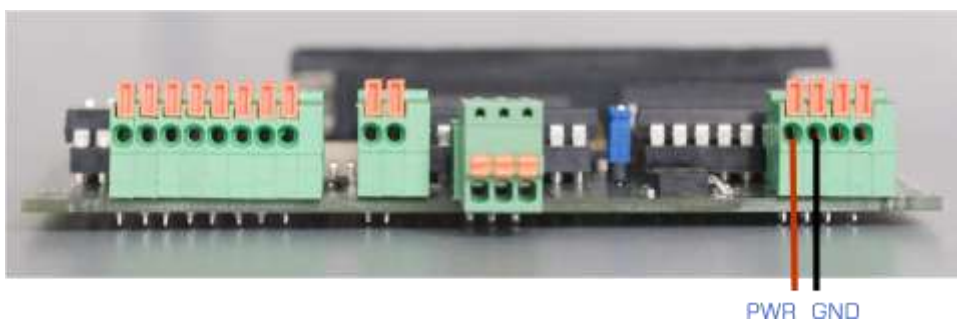
Fig 21 : connexion de l'alimentation sur l'OC32/NG
